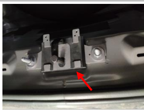
1.2 拆下原车锁扣组
