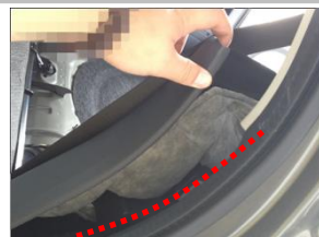
3.3 布正极线：将连接正极的线如图所示，通过尾箱后，把左 C 柱及迎宾踏板掀开，把正极线穿出（虚线）；同时把橙色解码器控制线从驾驶室反向延伸至上
