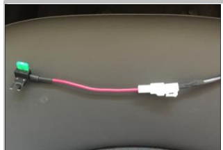
3.7 接正极线：把两个白色端口对接；
