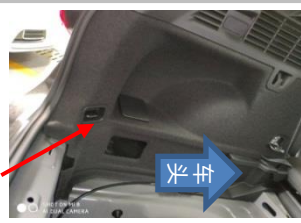
1.5 掰开尾箱左侧内饰板；将驱动盒伸到尾箱左侧空位处
