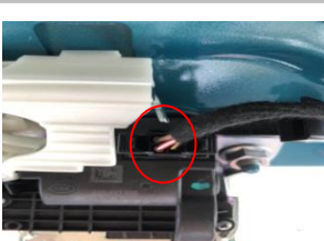
3.12 接门锁信号线：尾门原车门锁位置插头对插；
