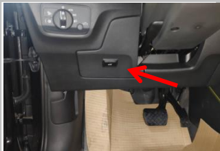
3.16 中控开关打孔位置：主驾 A 柱位置
