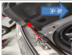
1.6 驱动盒以及拉线布置完成，如图所示，注意：内饰板等对插线后再还原
