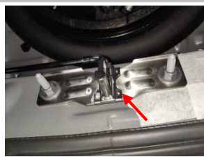
1.3 根据锁扣组箭头朝向正确安装，用原车螺母把垫板平行拧紧，注意居中安装
