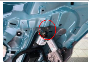
3.10 负极位置：尾门上有金属螺栓，接钣金螺栓
