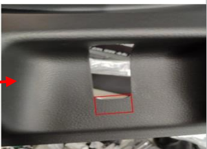
1.8,按图中方框标志位置割胶约11mm左右，具体割胶长度以实际装车为准。
