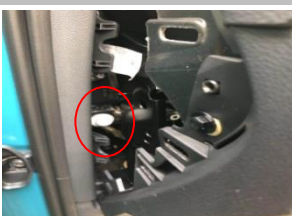
3.9 接中控开关线搭铁线，A 柱钣金螺栓，半圆金属片需贴紧钣金
