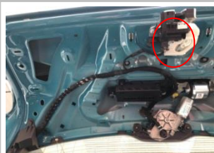
3.11 接门锁信号线：尾门原车门锁位置插头对插；
