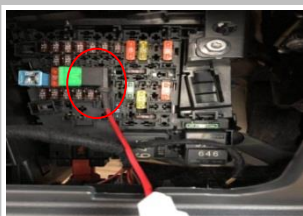
3.8 接正极线：看到原车保险盒，正极取电器位置，按如图方向安装取电器；
