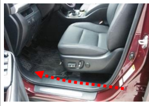
3.5 布正极线：把正极线引至前门迎宾踏板隐藏（虚线）；同时把橙色解码器控制线从驾驶室反向延伸至上尾门处；
