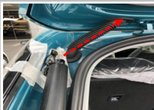
3.2 布电源线、驱动盒线、解码器控制线：把线束从车顶篷线套内胶条边缘穿进，使用引线器包扎好后穿线
